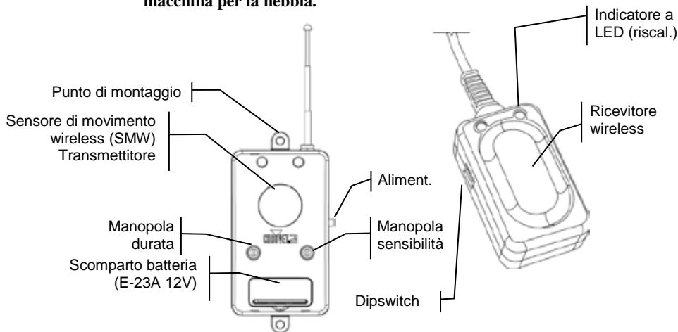
Met de WMS (draadloze afstandsbediening) kunt u compatibele nevelmachines activeren met bewegingsactivatie. Dit bestaat uit de zender met ingebouwde vertragingstijd en gevoelighedsknoppen voor de onafhankelijke besturing van maximaal 4 nevelmachines. Indien ze tegelijkertijd worden geaddresseerd kunnen er meer worden aangestuurd. Zie de onderstaande instructies om uw nevelmachine in te stellen voor gebruik met de WMS.
