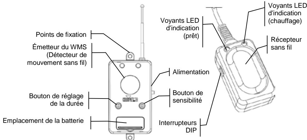
Der WMS (Wireless Motion Sensor) ermöglicht eine Auslösung kompatibler Nebelmaschinen mit Bewegungsaktivierung. Dieser besteht aus dem Sender mit integrierten Drehknöpfen für Verzögerungszeit und Empfindlichkeit zur voneinander unabhängigen Ansteuerung von bis zu 4 Nebelmaschinen. Bei einer gleichzeitigen Ansteuerung können auch mehr Geräte angesteuert werden. Informationen zum Einrichten Ihrer Nebelmaschine für den Betrieb mit dem WMS finden Sie unten.
