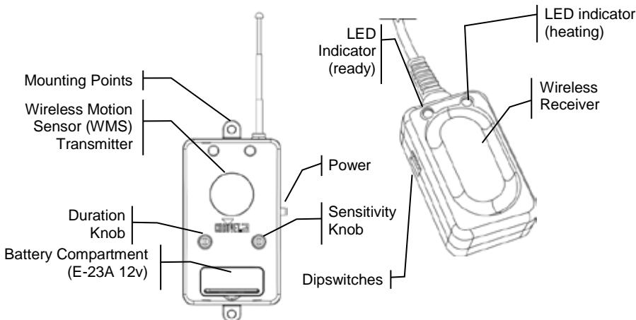
El WMS (Wireless Motion Sensor, sensor de movimiento inalámbrico) le permite poner en marcha automáticamente máquinas de niebla con activación de movimiento. Se compone del transmisor con mandos integrados de tiempo de retardo y sensibilidad para controlar hasta 4 máquinas de forma independiente. Se pueden hacer funcionar más si se les asigna la dirección simultáneamente. Vea las instrucciones siguientes, que le permitirán configurar su máquina de niebla para que funcione con el WMS.
